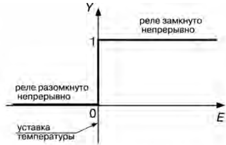
Рис. 3.8. Т-закон регулирования (релейный): полоса пропорциональности X_p равна нулю
