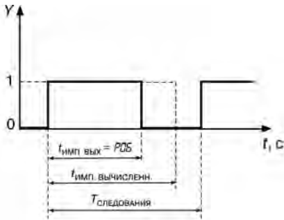
Рис. 3.10. Ограничение максимальной мощности. Временная диаграмма
