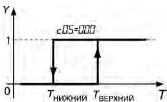
Рис. 3.14. Компаратор срабатывает по верхней уставке: Y = 1 - выходное реле замкнуто; Y = 0 - выходное реле разомкнуто
