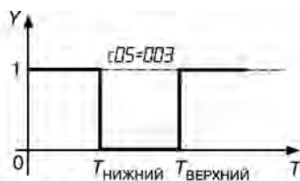
Рис. 3.17. Компаратор срабатывает вне установленных пределов
