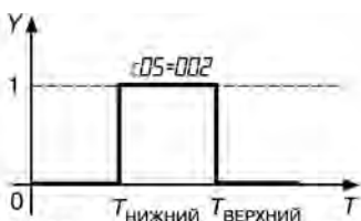
Рис. 3.16. Компаратор срабатывает внутри установленных пределов
