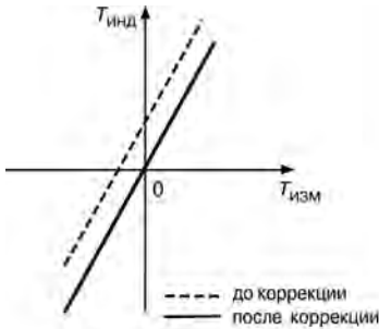
Рис. 3.5. Коррекция "сдвиг характеристики"
